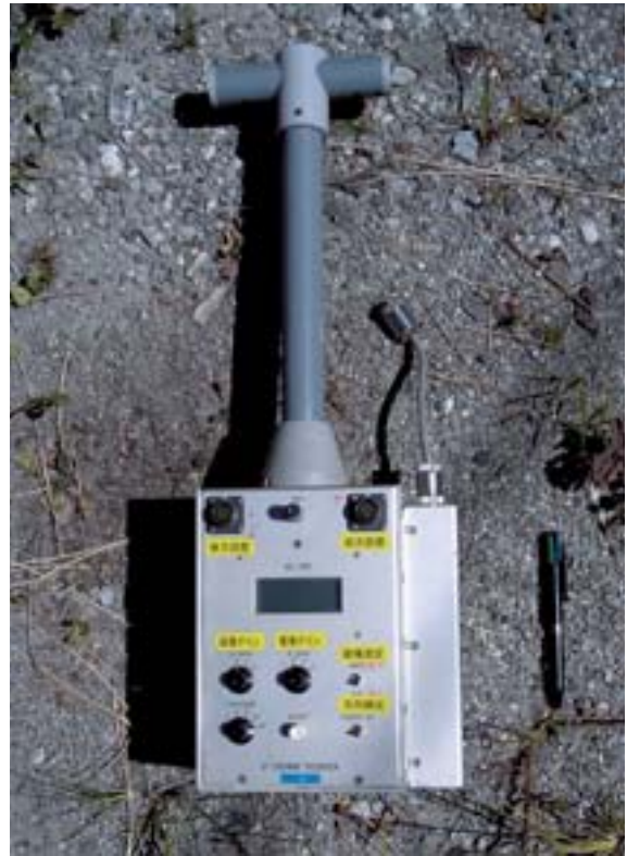
図 5 使用した VLF-MT 探査装置 (テラテクニカ社製 VL-101).
