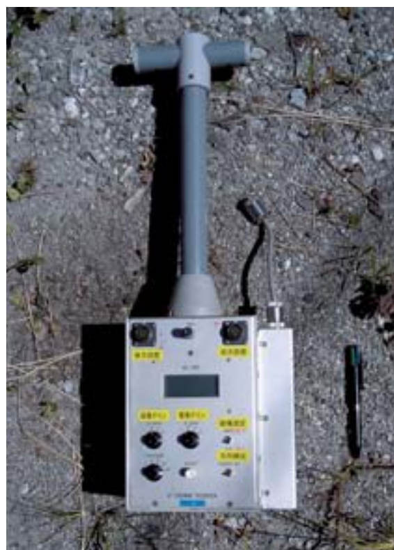
図 5 使用した VLF-MT 探査装置 (テラテクニカ社製 VL-101).
