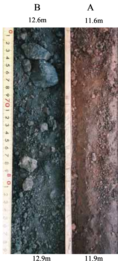
図8 第6コア中の火砕流堆積物 A: 最上部の高温酸化部, B: スコリアや岩片を含む火砕流本体部
