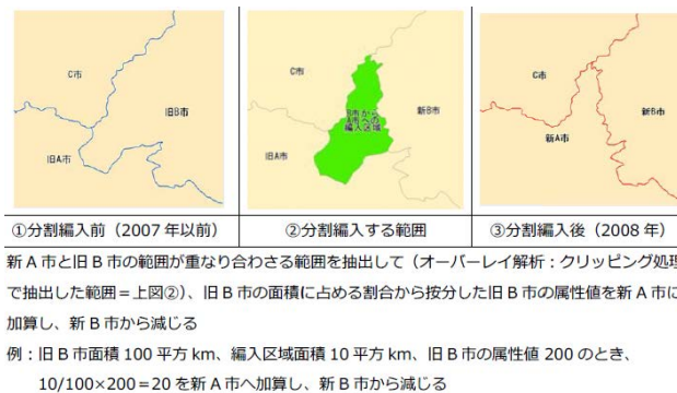
図 2 市町村の一部が他市へ編入された場合の 2008 年区画データ作成方法 Fig.2 Methodology for creating flood data considering municipal mergers.
