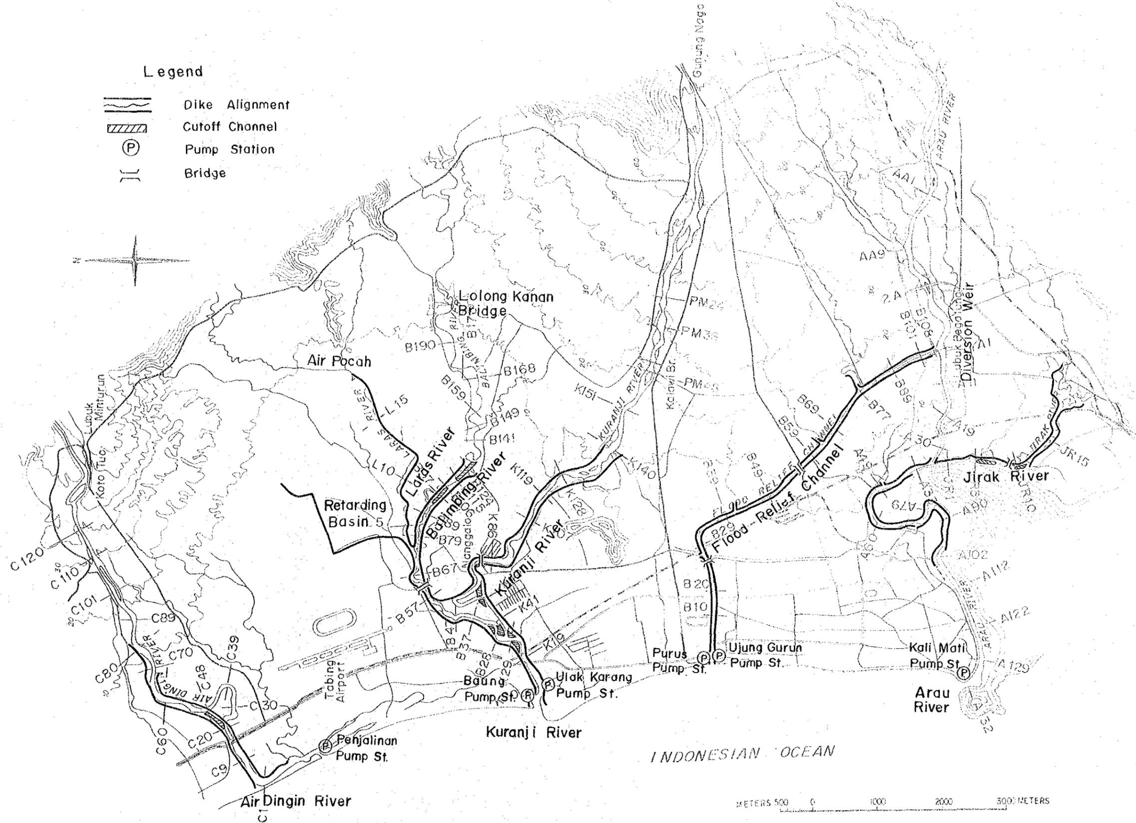
图 5.6 Lubuk Begalung 分流堰改修设计图 ( 全体设计图 )
