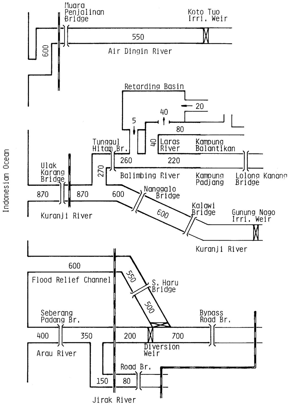
図6.2 緊急治水計画の河道法線図
