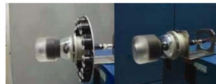
がれき内の全方向画像を取得するためのセンサヘッド
