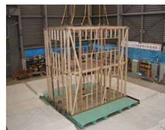
昭和30年代の工法で建設された木造住宅
