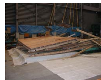
兵庫県南部地震震源取波3次元加振により倒壊した状況
