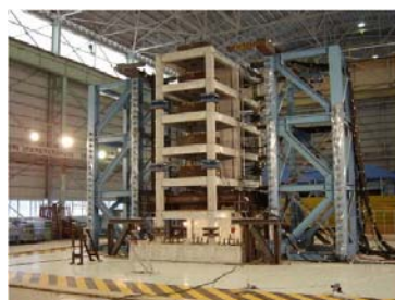
鉄筋コンクリート建物実験状況
