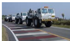
バイプロサイス車による発振（弾性波を地下に送り込む）
