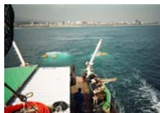
エアガンの発振作業（船尾の気泡はエアガンの発振による）
