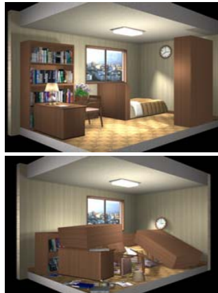
地震時の家具の動的挙動シミュレータ (上図：地震前；下図：地震後)
