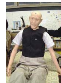
要救助者を模擬したロボット性能試験のためのレスキューダミー
