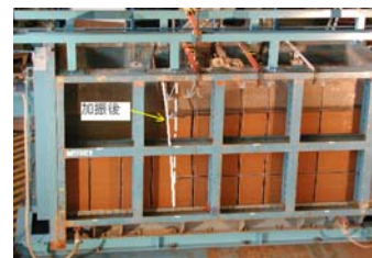
矢板式護岸の側方流動実験状況
