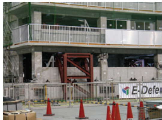
実大6層鉄筋コンクリート建物の震動破壊実験(2006年1月, 防災科研・兵庫耐震工学研究センター)
