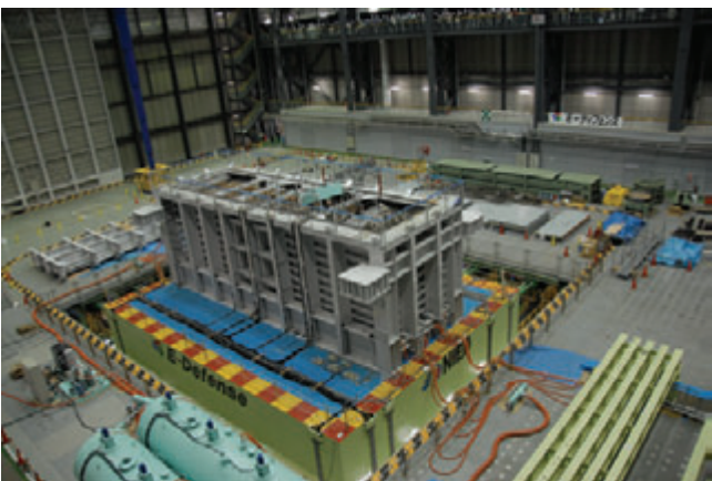
背後に杭基礎構造物を有する矢板式護岸の側方流動実験(2006年3月, 防災科研・兵庫耐震工学研究センター)
