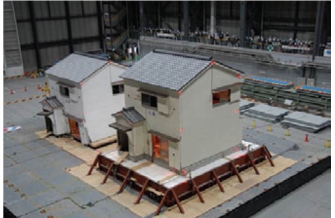
在来軸組木造住宅の耐震補強効果比較実験(㊦2005年11月, ㊦2007年2月, 防災科研・兵庫耐震工学研究センター)
