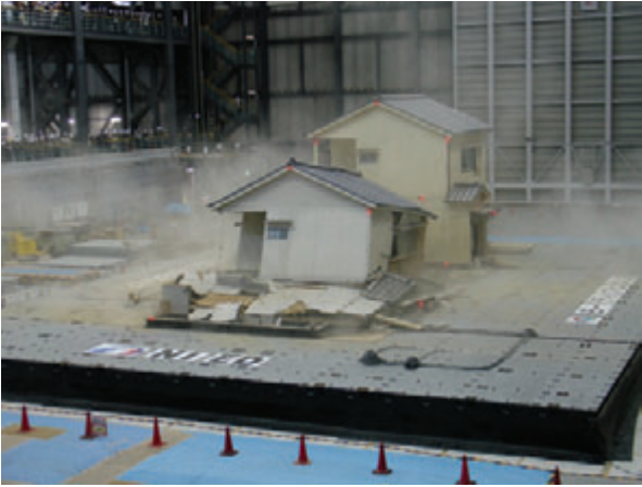
在来軸組木造住宅の耐震補強効果比較実験(㊦2005年11月, ㊦2007年2月, 防災科研・兵庫耐震工学研究センター)
