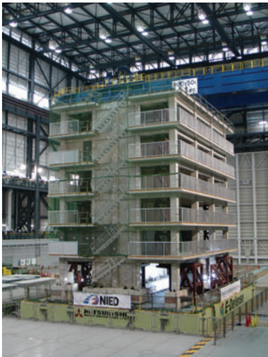
実大6層鉄筋コンクリート建物の震動破壊実験(2006年1月, 防災科研・兵庫耐震工学研究センター)
