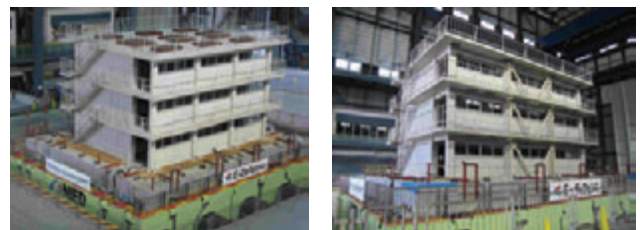
無補強試験体 補強試験体 写真5 実大3層建物の震動台実験
