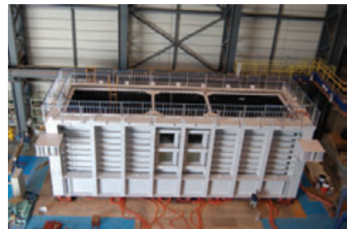
写真3 液状化に伴う側方流動実験の剛体土槽
