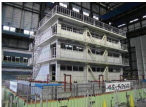
写真5 補強試験体 概観
