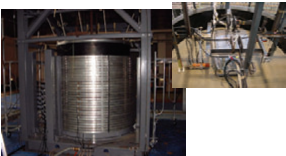
写真2 せん断土槽の外観と土槽表面の構造物設置状況
