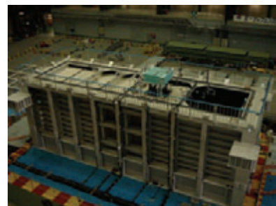
写真9 矢板式護岸の側方流動実験の試験体
