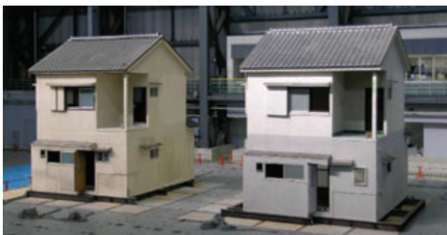
写真6 E-ディフェンス震動台実験(右:無補強建物、左:耐震補強建物) 入力は左右(桁行)方向がY方向
