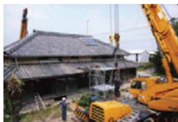
写真 8 明治 31 年築の伝統民家のクレーン 2 台による水平力繰返し載荷実験
