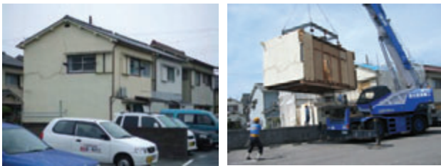
写真4 移築震動台実験試験体と移築方法
