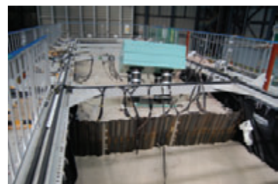
写真10 実験後の試験体(護岸前護面の水を排水した状況)
