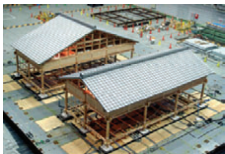
奥:L試験体 手前:S試験体 写真10 伝統木造住宅の実大震動台実験
