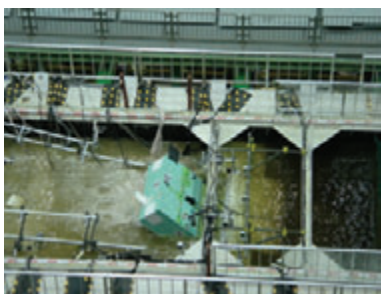
写真12 実験終了後のケーソンの傾斜と建造物の崩壊状況
