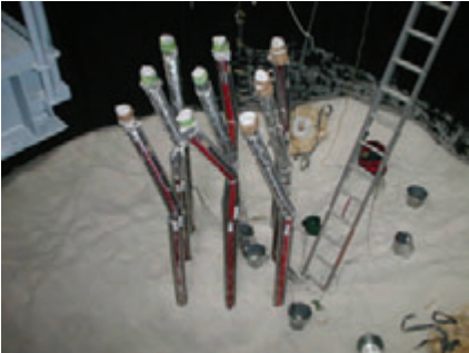
写真8 実験終了後における杭の折損状況
