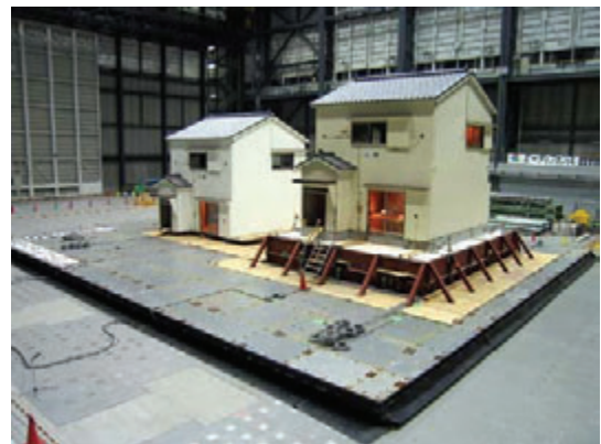
写真2 新築で再現した試験体(右は模擬地盤・基礎つき)
