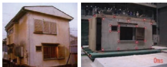
写真 3 移築試験体(左:元の建物、右:移築構面試験体)
