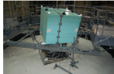
写真7 実験終了後における構造物の傾斜
