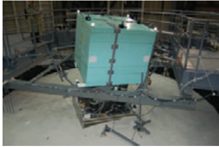
写真7 実験終了後における構造物の傾斜
