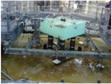
写真11 実験終了後における液状化による地盤の水没
