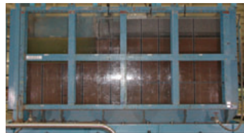
写真1 側方流動実験における試験体(加震前)
