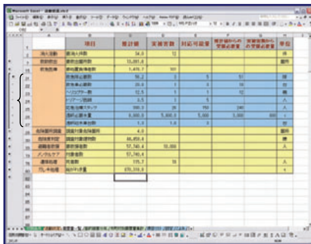
図2 応急対応需要量提示(詳細) この例では、救急医療勝に係る応急対応需要量推定値が提示され、実情報が入力されるとそれに即した対応需要量が算出される。また、救急車等防災資源を予め入力してあれば、即時的に不足分=応援需要量が算出されることから、応援要請判断として活用可能である。
