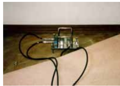
(2)室内の測定状況:絨毯などの上からの計測は極力避けている
