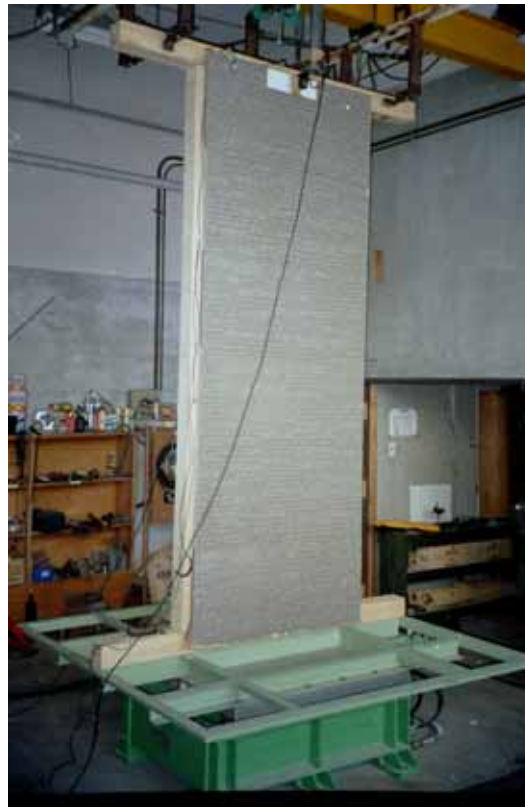
写真 2 外装構法の耐震性能評価のための基本振動特性把握実験の状況
