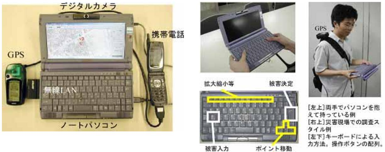
図6 現地被害情報収集システム(Pro-Infoシステム)の機器構成(右)と使用方法(左)
