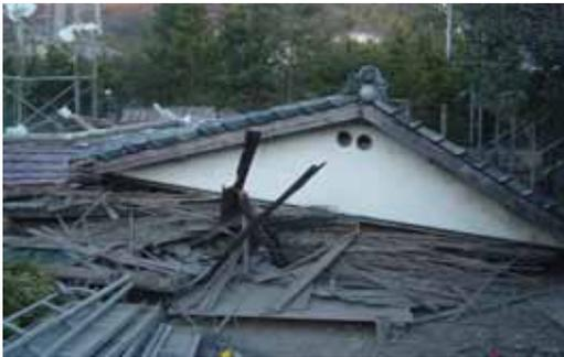
劣化住宅の引き倒し試験
