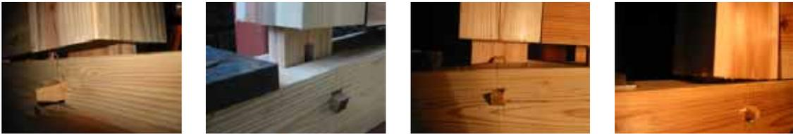
(c) 荷重実験による柱脚部の破壊状況
