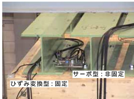
写真 2 換振器の設置例
