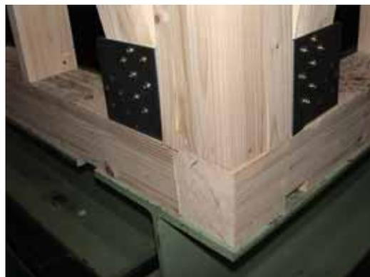
写真 5 隅角部の仕口の損傷
