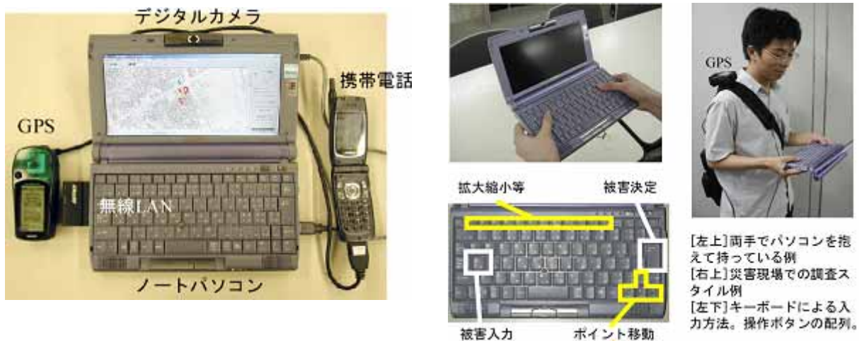
図2 現地被害情報収集システム（Pro-Info システム）の機器構成（右）と使用法
