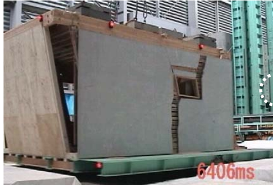
小窓開口側のモルタルの割れ
