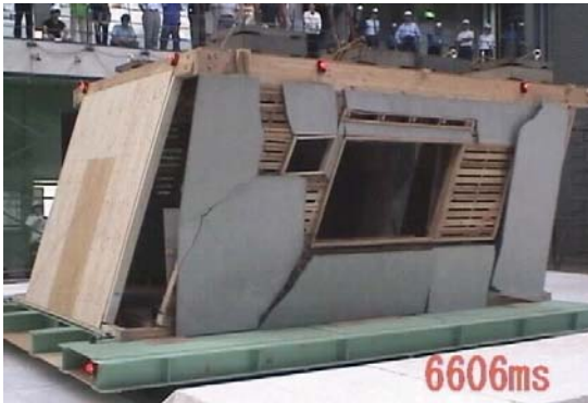
腰窓開口側のモルタルの割れ
