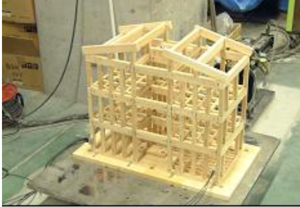
在来軸組木造戸建の縮小模型
