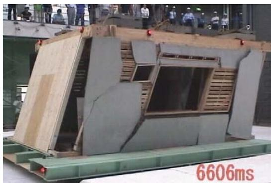
写真4 腰窓開口側のモルタルの割れ
