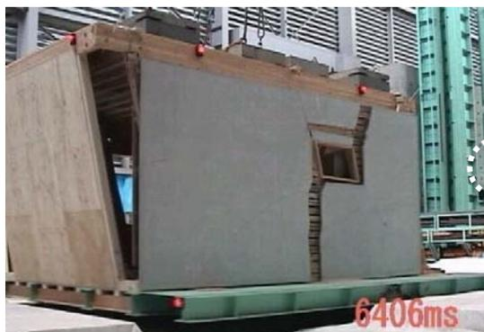
写真3 小窓開口側のモルタルの割れ
