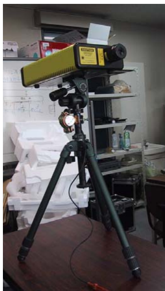
図7 レーザードップラー振動計と三脚頭部に取り付けた速度換振器
