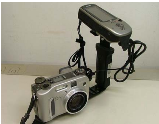
写真 6 GPS 付デジタルカメラ(左)、カメラ付 GPS 携帯電話（右、SANYO 社製の A5505SA、携帯電話会社は au）
