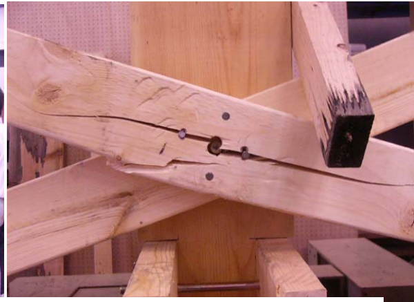
図 15 実験①の破壊状況
