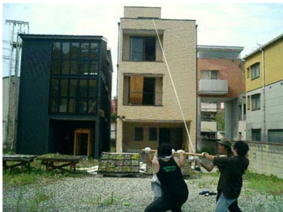
集成材と接合部金物の3階建の引張りによる自由振動 と 模型振動台実験
