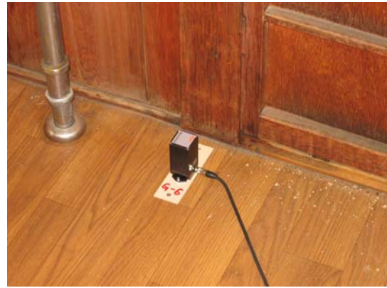
写真3 振動計測用加速度計
