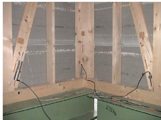
写真 17 柱脚変位計の設置
