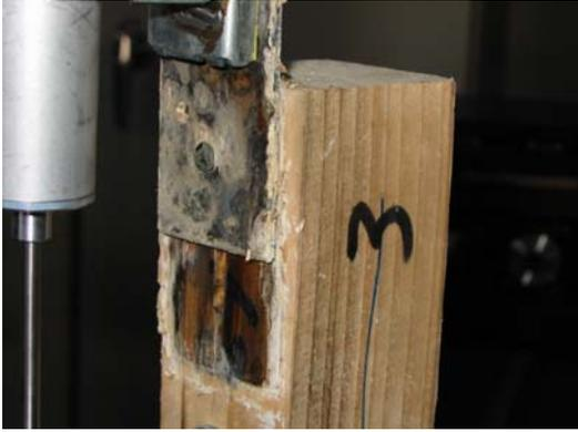
写真 10 腐朽材(4 か月)
