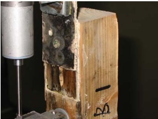
写真 12 腐朽材(6 か月)
