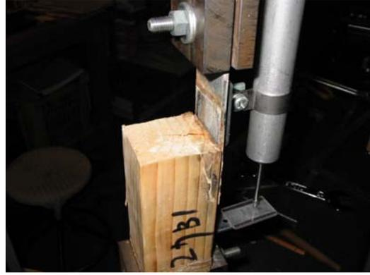
写真 11 腐朽材(4 か月)
