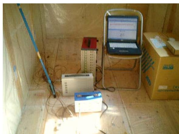
図2 自由振動及び測定用のセンサ
