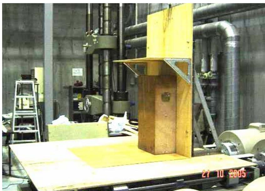
図1 木製ブロックを用いた振動台実験の様子
