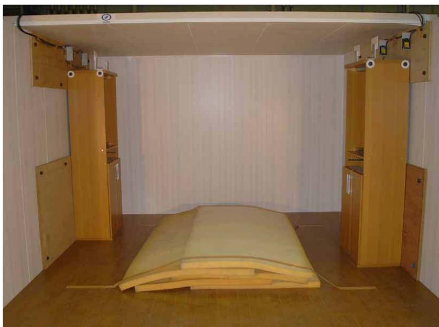
図6 実スケール家具を用いた振動台実験の様子
