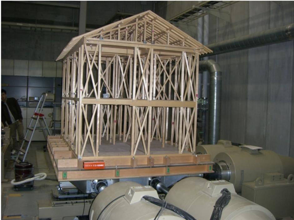
木造軸組模型の振動台による起振デモンストレーションの様子
