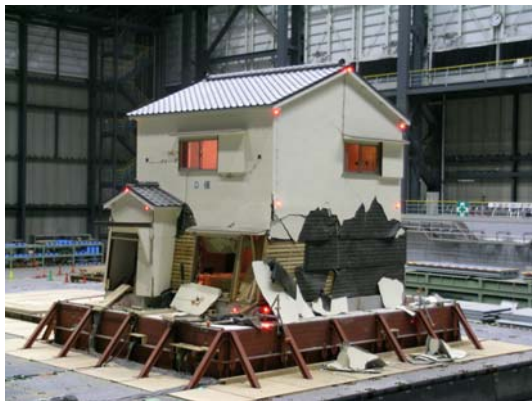
写真5 JR 鷹取フルスケール 3回目加振後、 4回目加振後（D棟倒壊）
