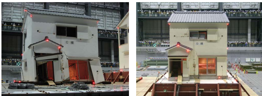
写真2 JR鷹取フルスケール 1回目加振後（左：C棟、右：D棟）
