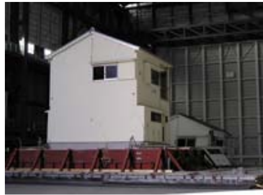
写真4 JR 鷹取フルスケール 2回目加振後 C棟倒壊（上段：C棟、下段：D棟）
