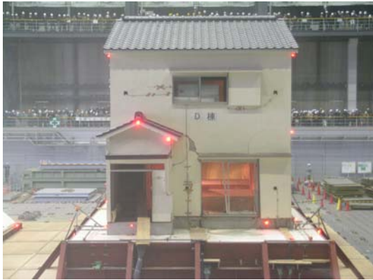
写真4 JR 鷹取フルスケール 2回目加振後 C棟倒壊（上段：C棟、下段：D棟）
