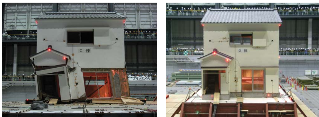
写真3 JR鷹取60% 余震想定加振後（左：C棟、右：D棟）
