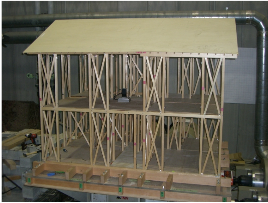
図 6 木造軸組模型の起振器による起振デモンストレーションの様子
