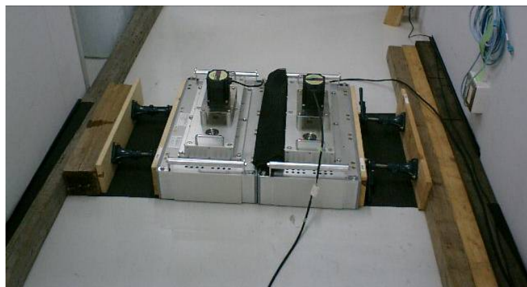
図 7 実建物の起振器の様子
