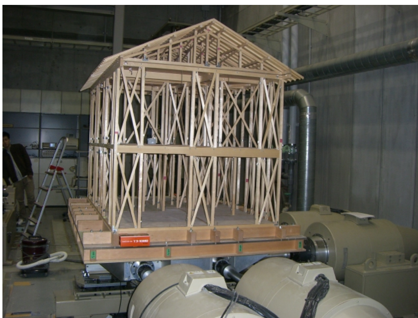
図 5 木造軸組模型の振動台による起振デモンストレーションの様子
