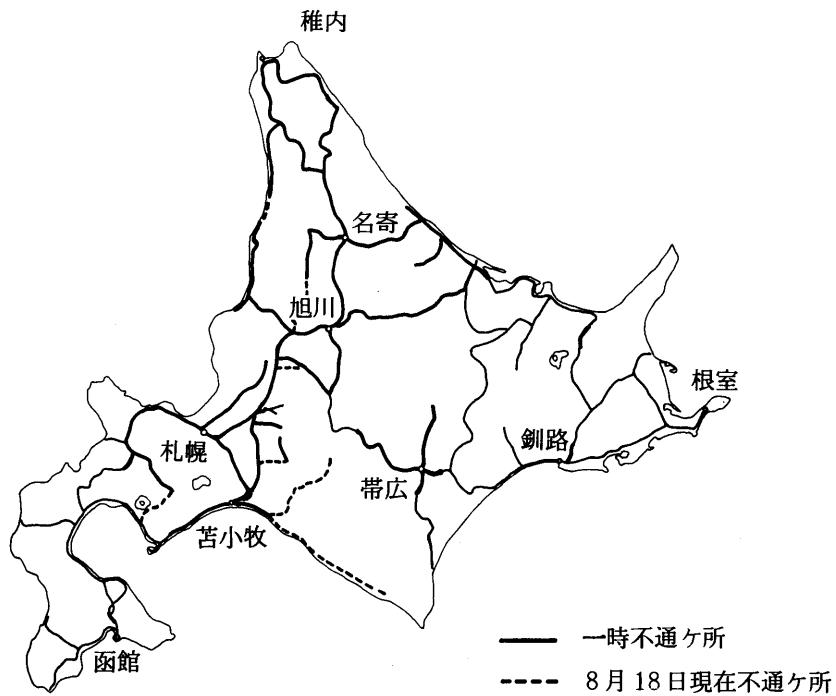
図 2.1 国鉄北海道総局管内被災線路図
