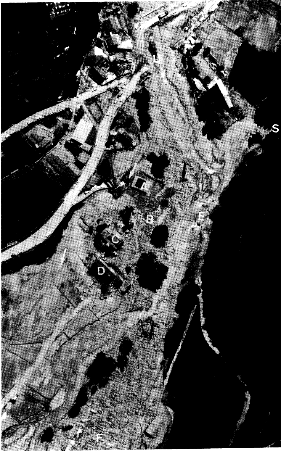
写真29 土石流堆積末端域にあたる宇原川, 仙仁川合流点付近の空中写真 (8月25日 長野県警撮影). A: 全壊, B: 流失, C: 床上浸水, D: 半壊 (Cの家は土石の流れがわずかにそれたため浸水だけで済んだ), U: 宇原川, S: 仙仁川, E: 合流点, F: 土石流堆積の末端, 黒矢印: 土石流の主流の流下方向, 白矢印: 洪水流.
