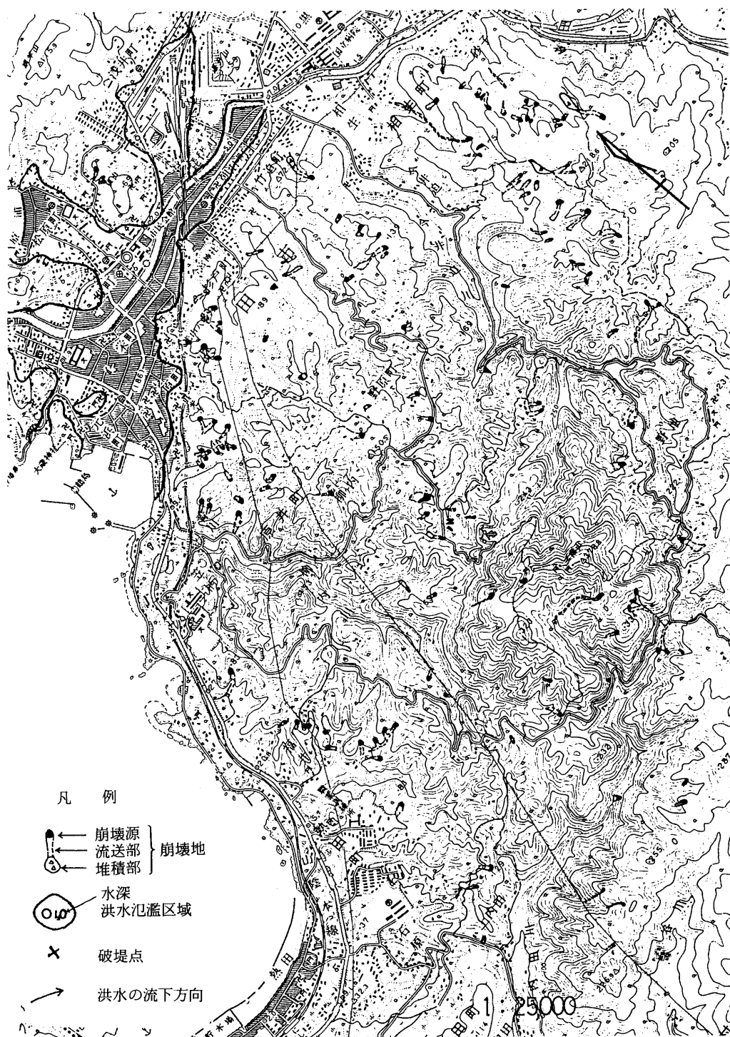
図 4.15 58年災害時の浜田市周辺の崩壊の分布（アジア航測1983）
