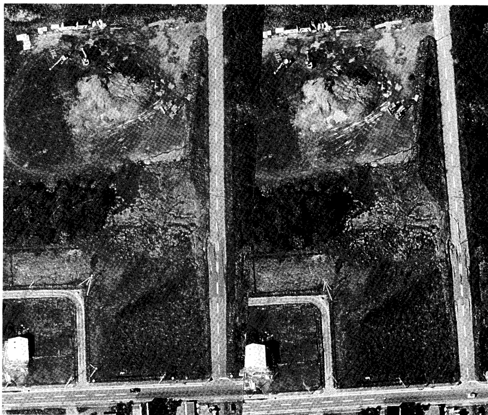
写真25 中標津町造成地の盛土すべりのステレオ空中写真(中日本航空撮影)
