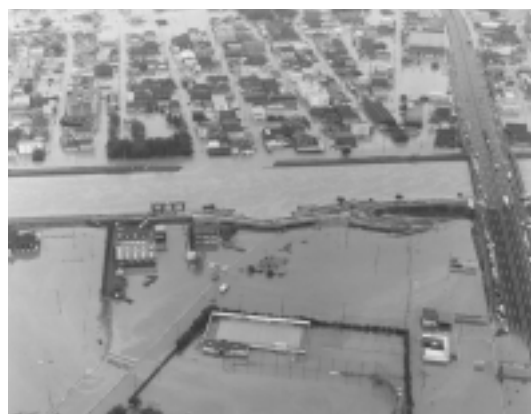
写真1 名古屋市西区あし原地区の新川破堤点付近の洪水氾濫状況, 2000年9月12日撮影(提供: 愛知県, 2000)
