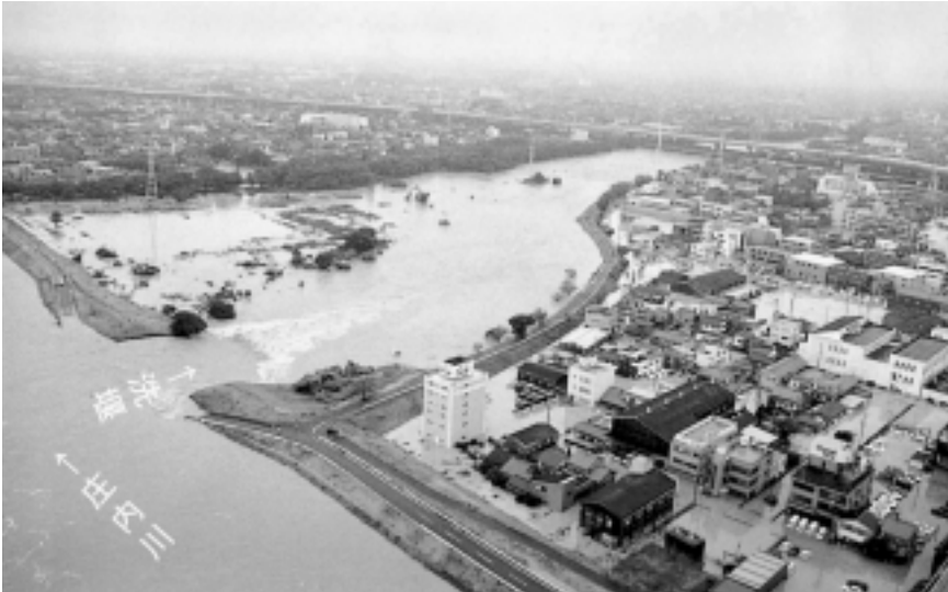
写真3 洗堰を越流して新川に流入する庄内川の洪水（国土交通省提供）
