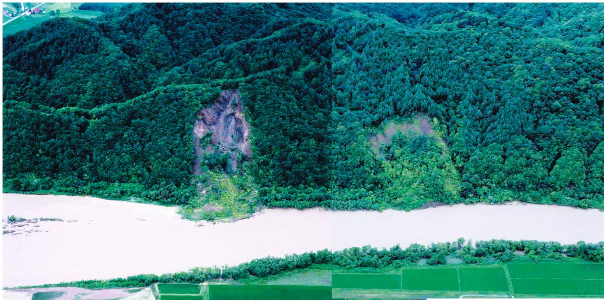
図9 穂別町栄付近の鶴川右岸の斜面崩壊状況、多量の土砂と流木が河川に流れ込む（株式会社シン技術コンサル提供、平成15年8月10日撮影）。
