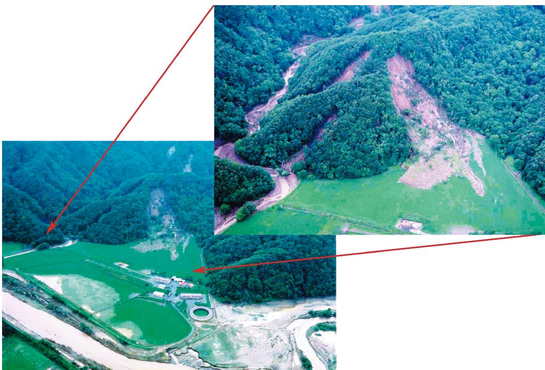
図絵 8 門別町正和地区の厚別川右支川沿い斜面の崩壊による流木生産および河川への土砂・流木の流出状況（株式会社シン技術コンサル提供，平成 15 年 8 月 10 日撮影）
