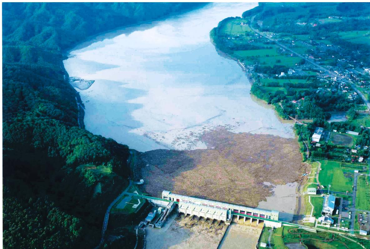
図10 沙流川上流の二風谷ダムで堰き止められた流木。流木量は6万7千m<sup>3</sup>と推定された（2003年9月5日現在、株式会社シン技術コンサル提供、2003年8月10日撮影）。
