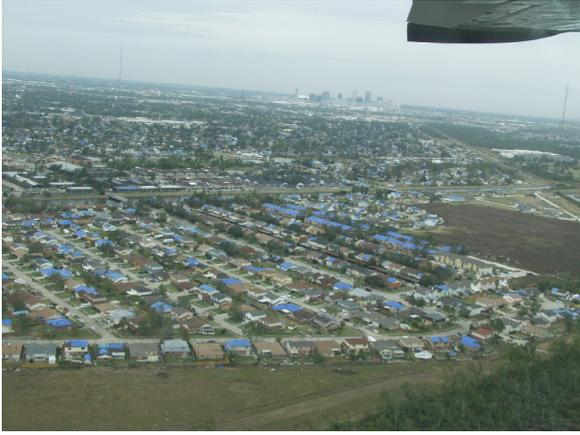
写真 3.1 風害：住宅の屋根被害
