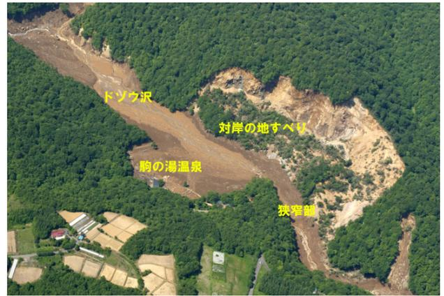
写真3 駒の湯温泉を襲った土石流と対岸の地すべり
