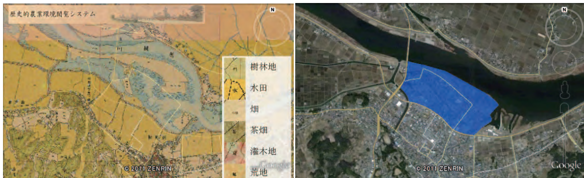
図 11 香取市佐原付近の明治時代の地形図(左)と現況の衛星写真(右). 青で示す範囲は液状化範囲
