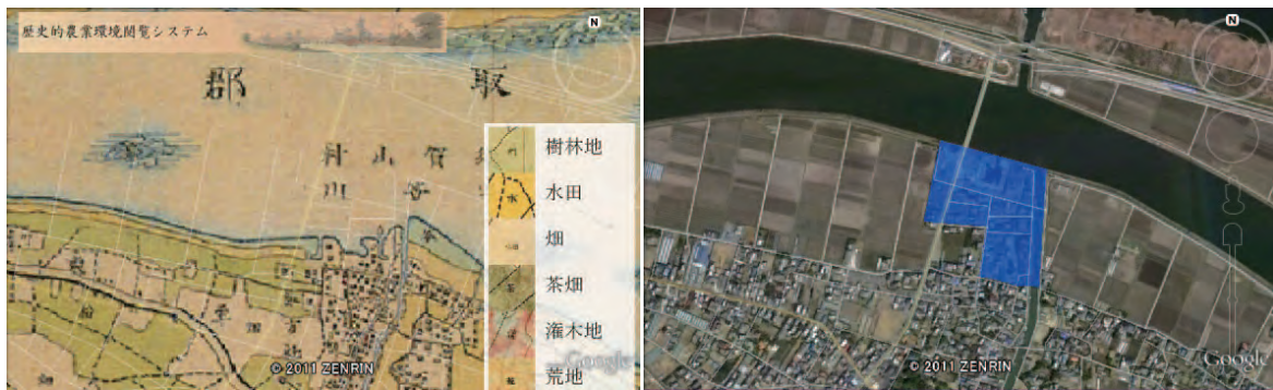
図6 東庄町笹川付近の明治時代の地形図(左)と現況の衛星写真(右). 青で示す範囲は液状化範囲
