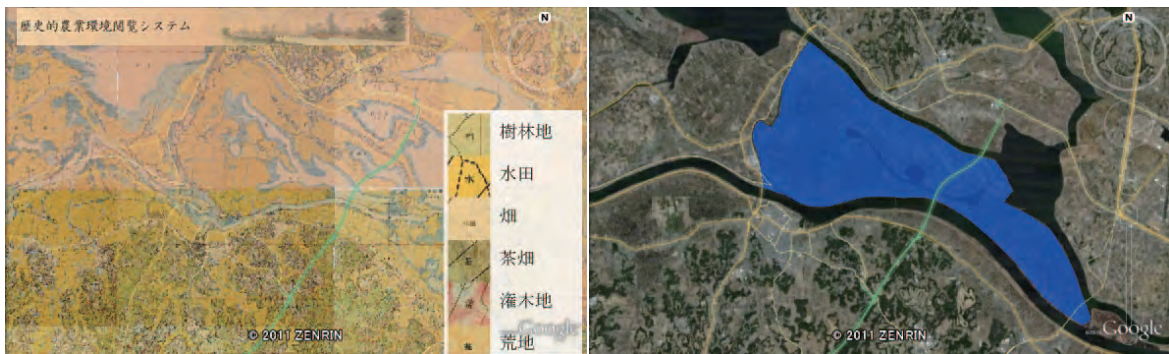
図 13 香取市篠原付近の明治時代の地形図(左)と現況の衛星写真(右). 青で示す範囲は液状化範囲.
