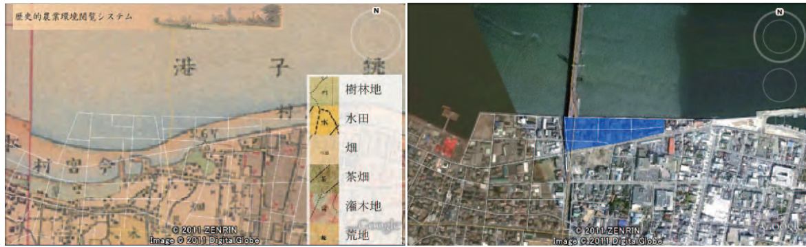
図5 銚子市大橋付近の明治時代の地形図(左)と現況の衛星写真(右). 青で示す範囲は液状化範囲
