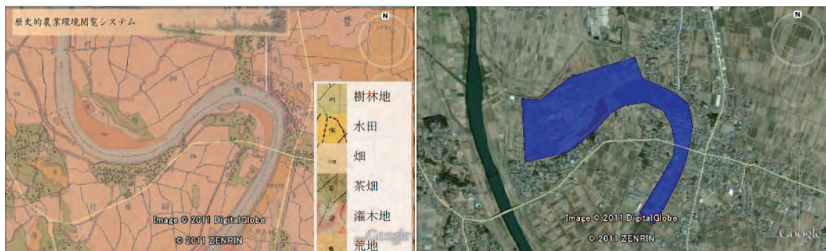
図 17 下妻市千代川付近の明治時代の地形図(左)と現況の衛星写真(右)。青で示す範囲は液状化範囲
