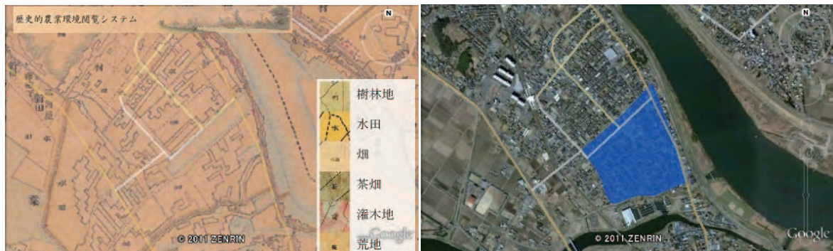
図 16 我孫子市布佐付近の明治時代の地形図(左)と現況の衛星写真(右)。青で示す範囲は液状化範囲
