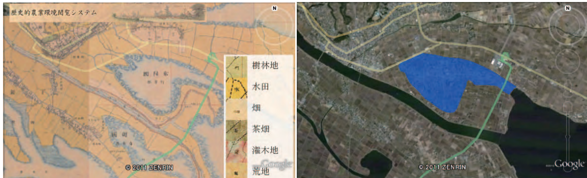
図 10 潮来市日の出付近の明治時代の地形図(左)と現況の衛星写真(右). 青で示す範囲は液状化範囲
