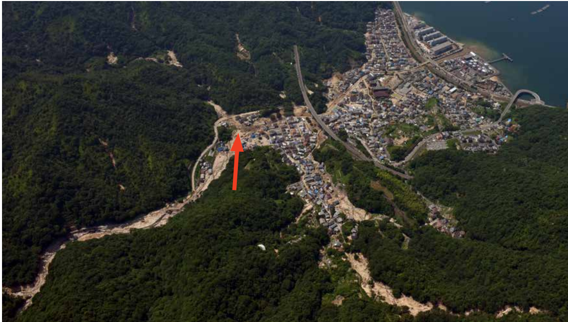
口絵3 斜面崩壊により多くの死者が出た小屋浦地区。矢印付近が口絵4に当たる。 (撮影：2018年7月25日、広島県坂町小屋浦)
