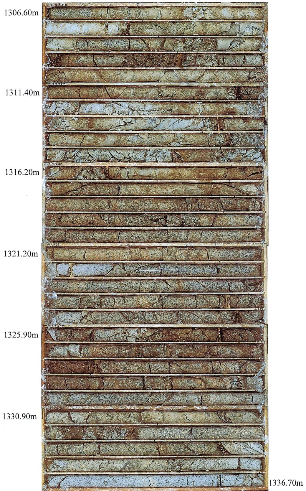
図5 1,300m破碎帯部におけるコア写真(1,306.6~1,336.7m)。図中の深度は掘削ドリルパイプの長さを足し合わせて算出した“コア深度”である。
