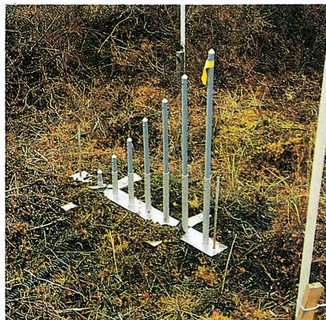
写真4 気象観測点に設置した雪温計のセンサー
