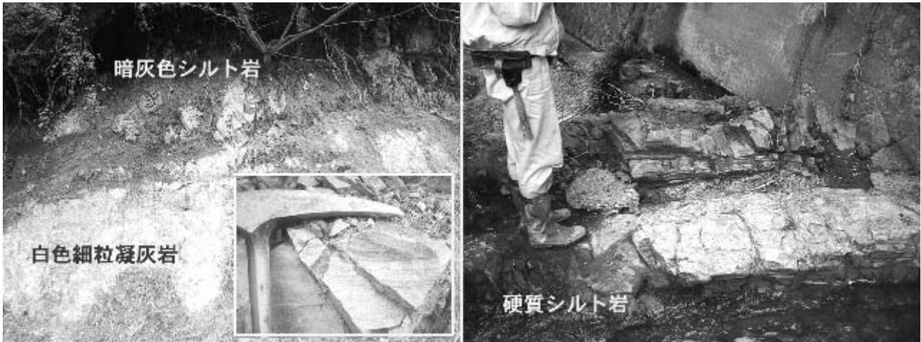
図9 ポーリングサイト東南東2kmほどの釜谷付近に露出する木ノ根層の硬質シルト岩および白色細粒凝灰岩。木ノ根層の最下部に位置することから、白色凝灰岩は鍵層Kn-1であると推定される。道路脇の露頭(写真左)の地層は緩傾斜であるが、100mほど南方の河床では、地層は北に50°程度で傾斜しており、南側近傍に南側隆起の断層の存在が示唆される。撮影位置は図6に示す。
