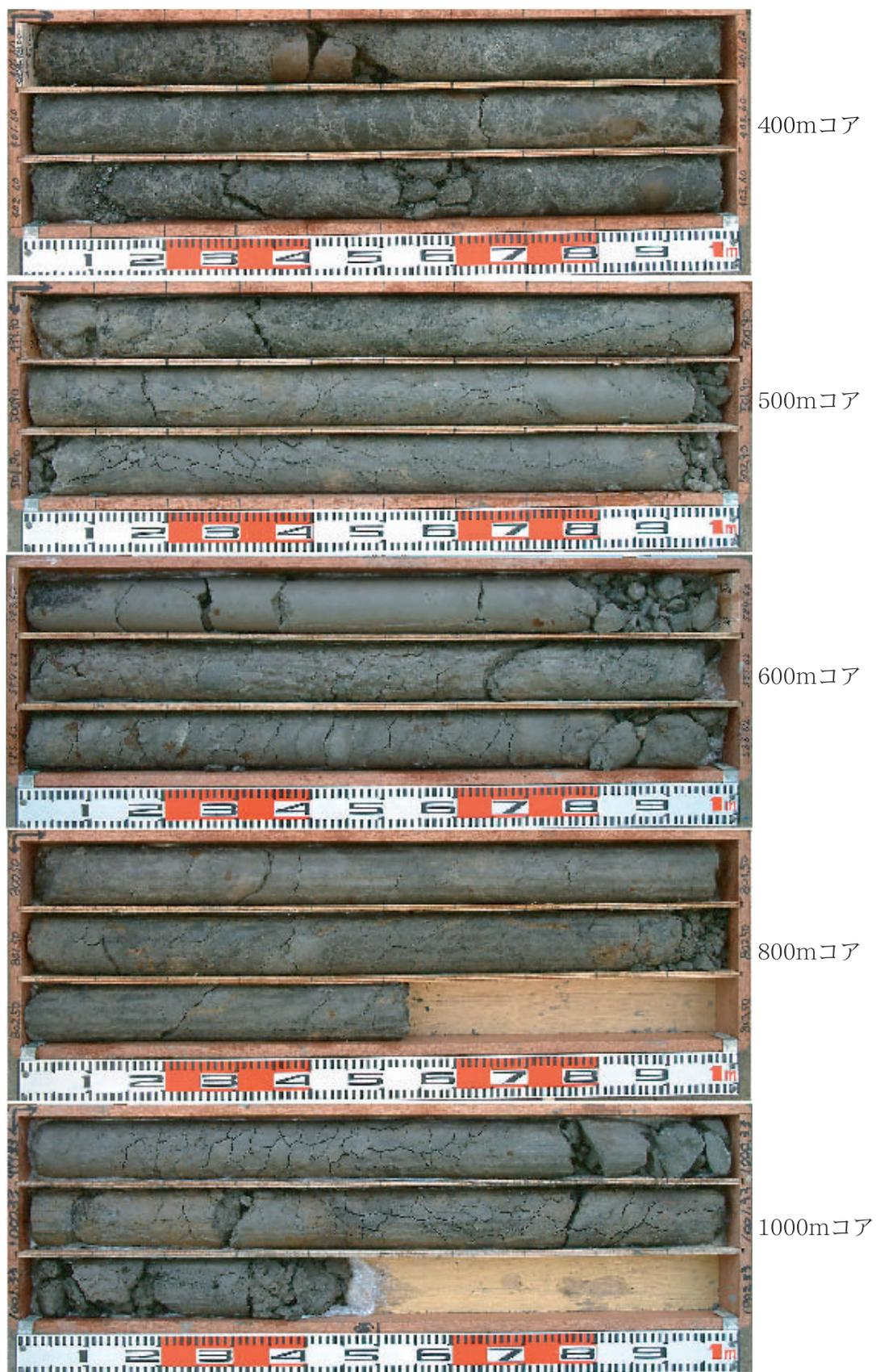
図5b スポットコア試料（400～1,000m）の写真
