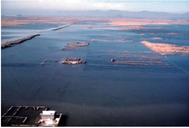
口絵22 破堤した海岸堤防から海水が流れ込み、浸水した広大な干拓地。家の土台と浴槽だけが残った。 (中村三郎氏撮影)
