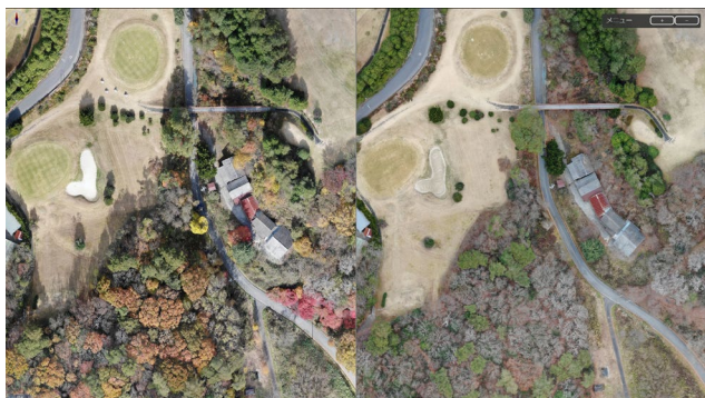
図 5 比較アプリのインターフェイス 災害前後のオルソ画像を左右に並べて比較するモード。このほか、スライダーを左右に動かして比較することもできる。図では、平時の訓練で作成した 2 時期のオルソ画像を表示しているため、左右の画像には、紅葉の有無程度の違いしか見られない。左は 2019 年 11 月 21 日、右は同年 12 月 22 日撮影
