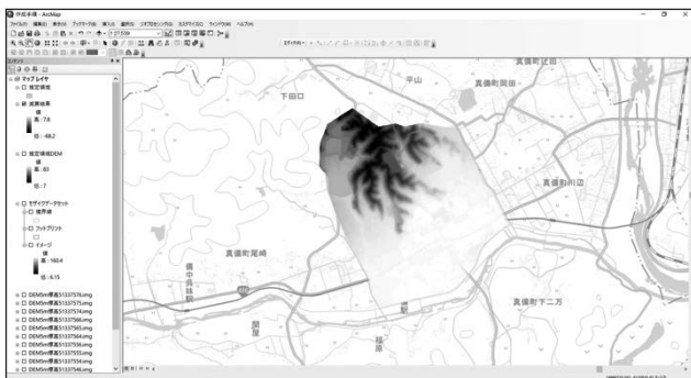
図 15 スペーシャルアナリストによる減算 Fig. 15 Subtraction by Spatial Analyst.
