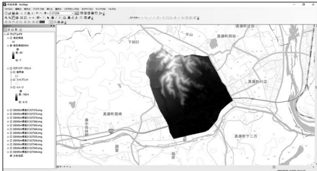
図 14 マスクで対象領域抽出 Fig. 14 Extract Target Area by Mask.
