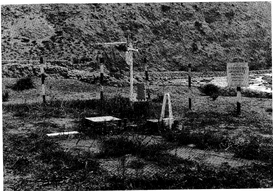
図 5 山地水文観測装置の設置状況
