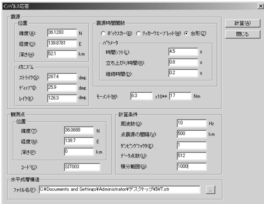
図E.2 (e) SMDA2における離散化波数法を用いた地震波合成手順(パラメータボックス)
