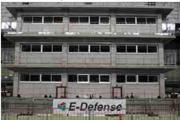
写真 A.2.1 旧基準試験体 X1 構面 (加振前)
