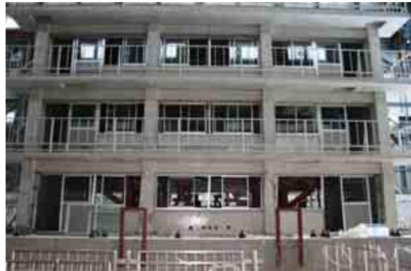
写真 A.1.2 旧基準試験体 X3 構面 (最終加振後)
