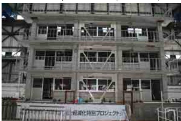
写真 A.3.1 補強試験体 X3 構面 (加振前)
