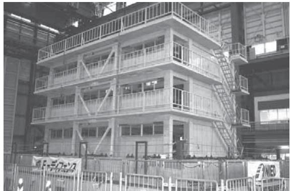
写真 3.2 実大実験 補強試験体
