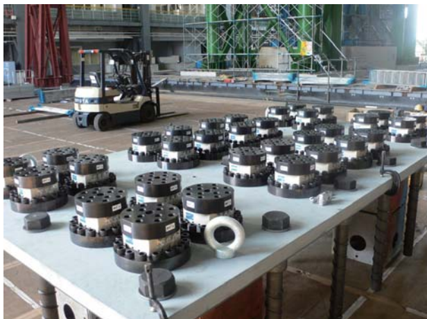
写真 19 試験体天端三分力計 (32 個設置) Photo 19 32 loadcells at the column top.
