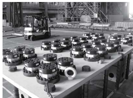
写真 2-1 橋脚天端支承固定鋼板上の三分力計
