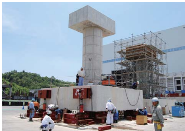
写真 12 試験体ジャッキアップ
