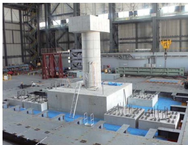
写真 15 C1-5 試験体 震動台上設置
