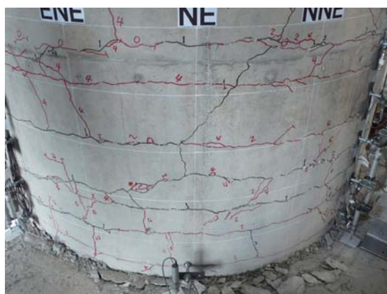
写真 47 C1-5(2)加振後北東面
