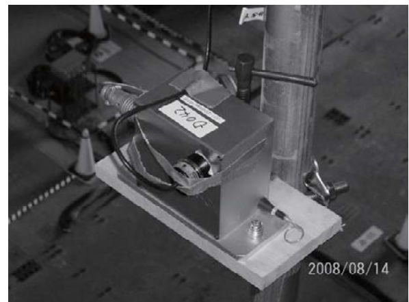
写真 2.1 ワイヤー式変位計 (側面に加速度計設置)
