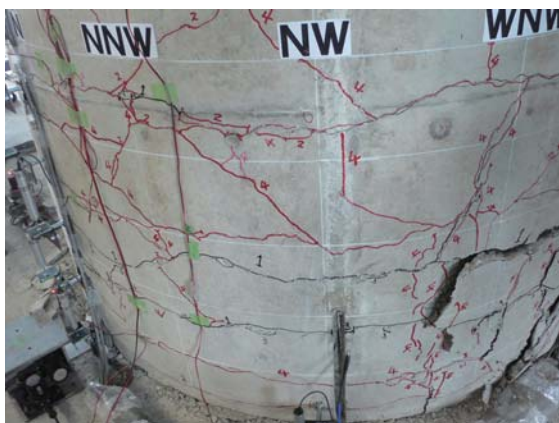
写真 42 C1-5(2)加振後北西面
