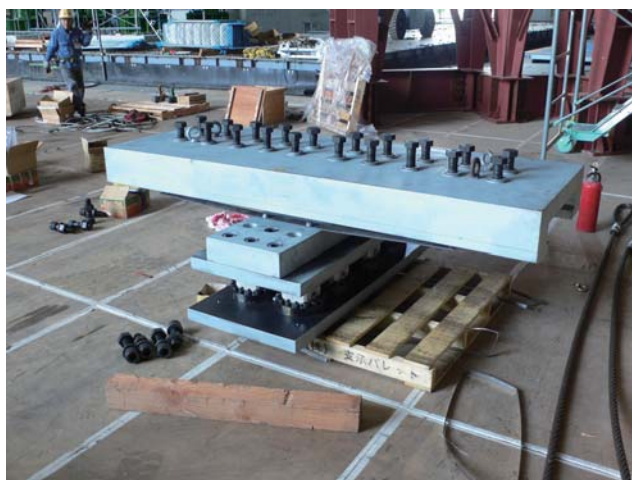
写真 25 端部架台上三分力計・可動支承 支承条件：直角方向固定
