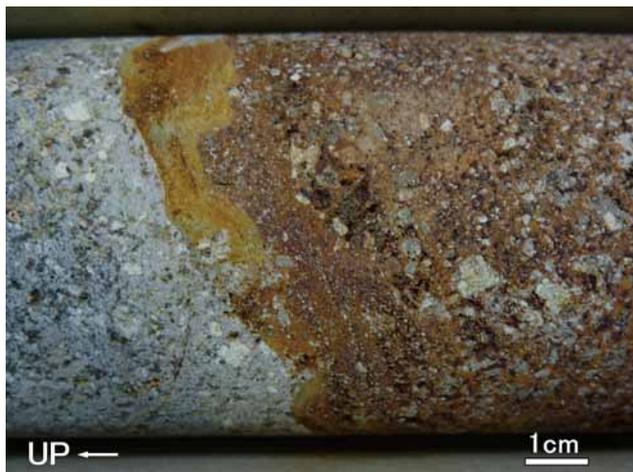
写真7 万膳コア深度 123.8 m, 変質した凝灰角礫岩に含まれる砂 - シルト薄層
