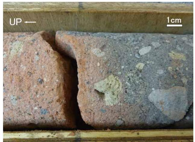
写真17 夷守台コア深度101.4 m, 軽石を含む安山岩質の凝灰角礫岩(火砕流堆積物)
