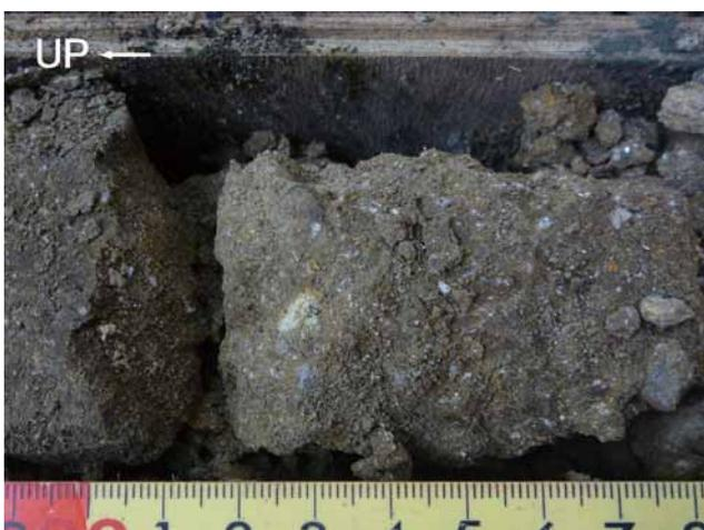
写真11 夷守台コア深度 8.9 m, 土壤中に散在する軽石と石質岩片
