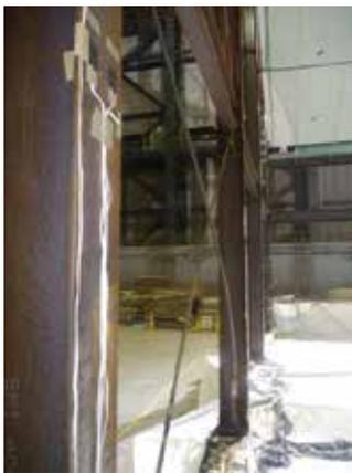
写真 3.1 K-NET 仙台波 80% 加振後の壁ブレースの座屈変形
