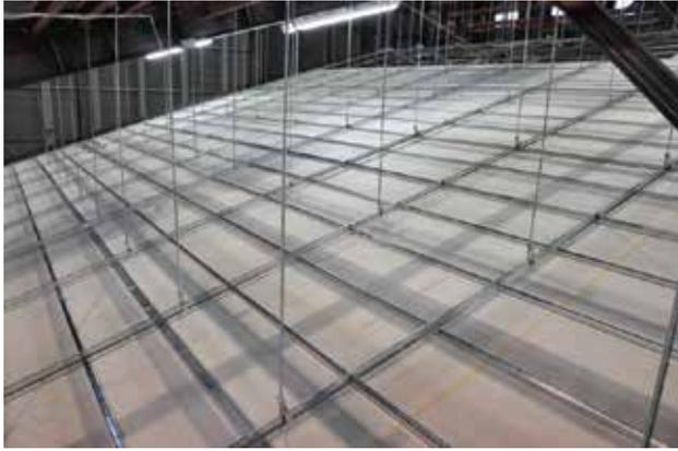
(a) 建物試験体内部に設置した天井
