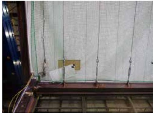
ロックウール吸音板の脱落
