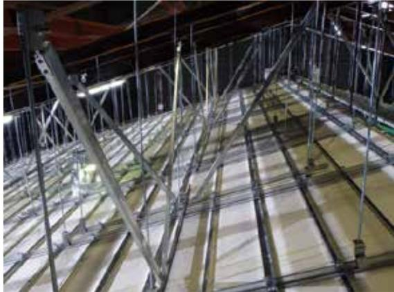
(a) 試験体内部に設置した天井
