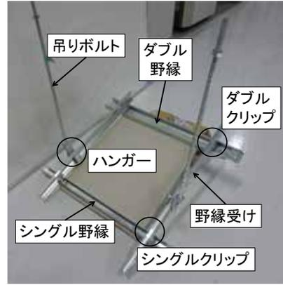
(b) 天井試験体の模型
