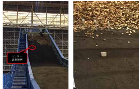
図 5 大型模型時実験センサー設置例
