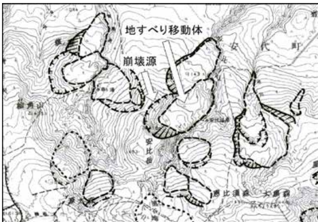
図4 地すべり地形分布図「八幡平」の一部 (防災科研, 1984) Fig. 4 Example of landslide map in Hchimantai area (NIED, 1984).
